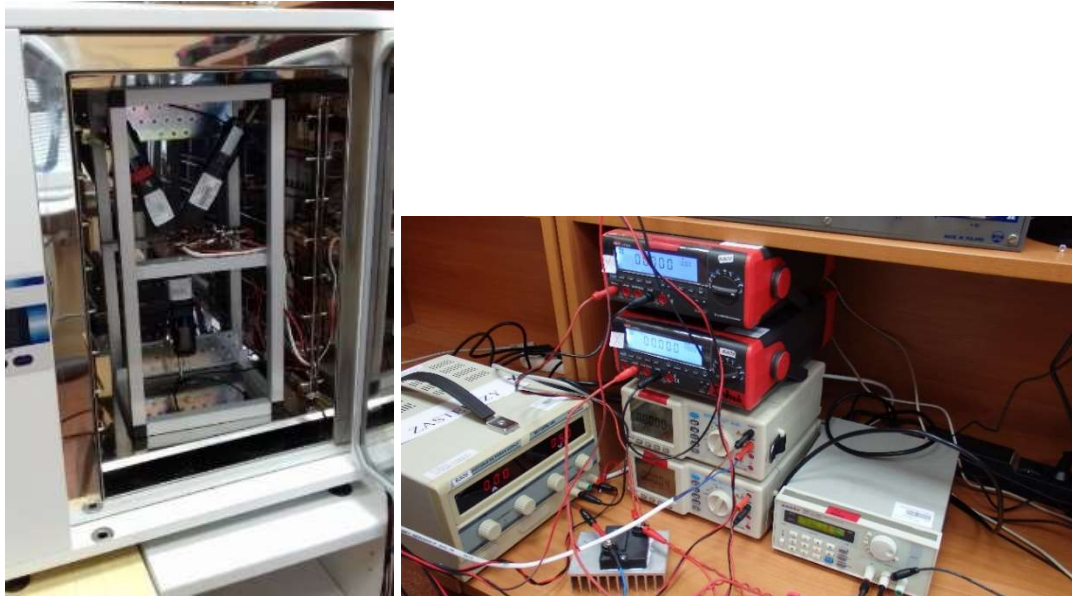
Rys. 8.6 Widok komponentów stanowiska do pomiaru parametrów cieplnych transformatora o schemacie z rys. 8.5
