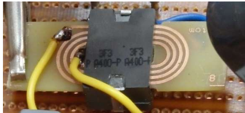
Rys. 5.3 Badany transformator z rdzeniem E22/6/16 z materiału 3F3
