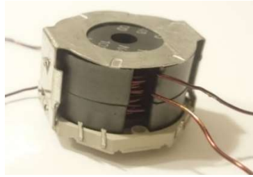
Rys. 5.4 Badany transformator z rdzeniem kubkowym
