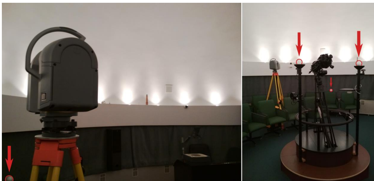
Rys. 6.16. Aparatura pomiarowa w planetarium AMW w Gdyni ze wskazaniem (czerwone strzałki) wybranych kul służących do późniejszej rejestracji chmur punktów.
