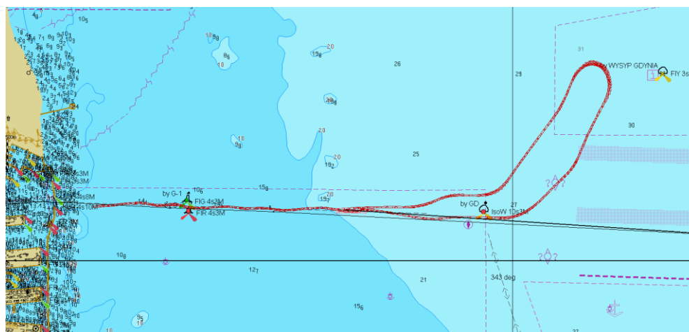
Rys. 5.16 Mapa obszaru przewidzianego do pogłębienia oraz lokalizacja wysypiska w ramach badanego projektu wraz z ukazaniem trajektorii modelowej pogłębiarki Volvox Terranova
