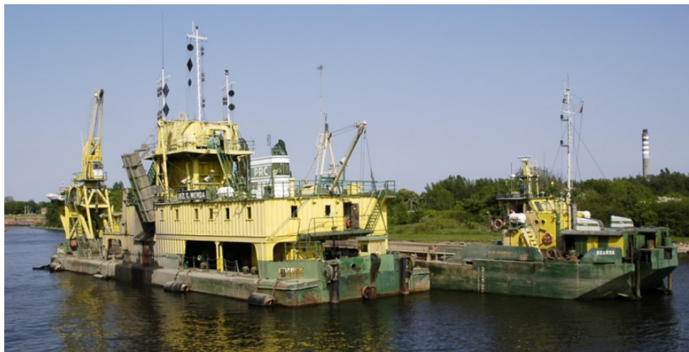
Rys. 3.4 Pogłębiarka wieloczerpakowa z przycumowaną szalandą w trakcie pracy na kanale portowym [103]
