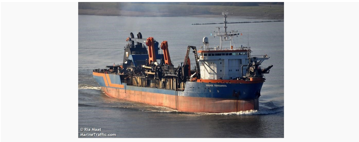
Rys. 5.11 Pogłębiarka ssąca samobieźna Volvox Terranova przedsiębiorstwa Van Oord [107]
