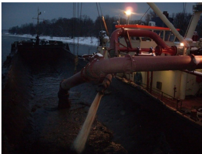
Rys. 2.2 Praca refulera podczas opróżniania szalandy przy użyciu tzw. płuczki [103]
