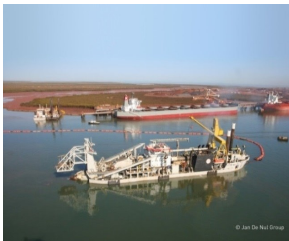
Rys. 2.3 Pogłębiarka ssąco-skrawająca pracująca w porcie, wykorzystująca pływający rurociąg refulacyjny do transportowania urobku [102]
