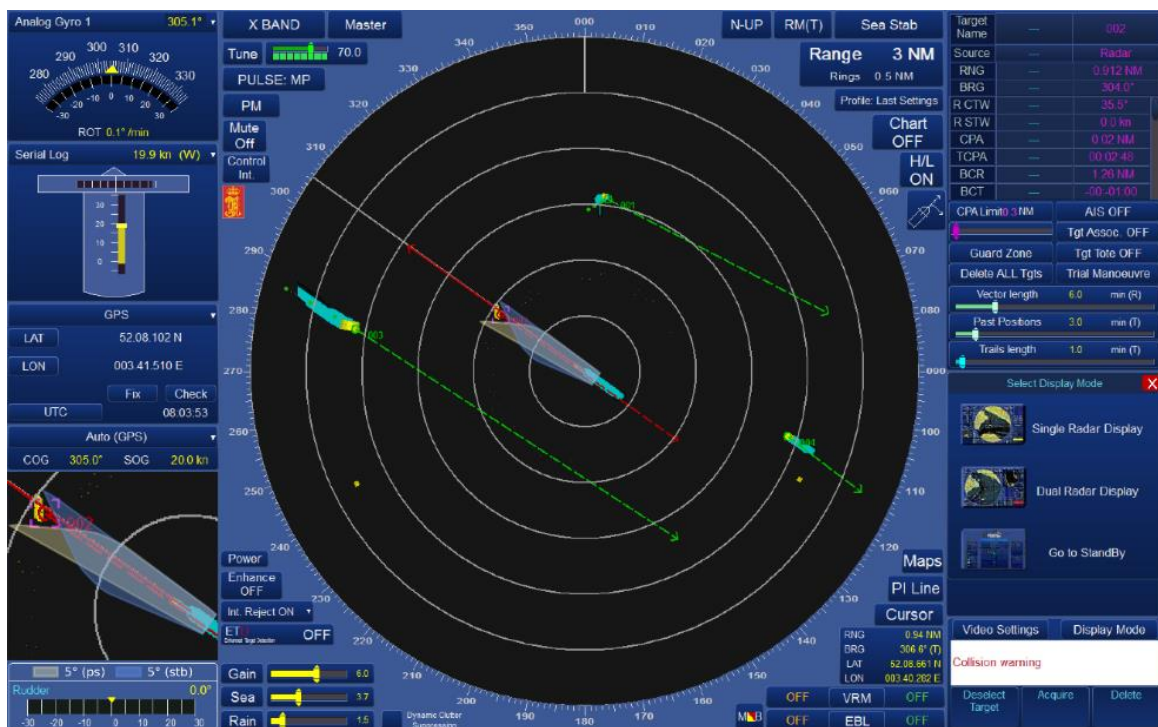
Rysunek 55. Możliwa wizualizacja CADCA w formie nakładki na radar Manta firmy Kelvin Hughes pracujący na zakresie 3 Mm (Gil, 2021).
