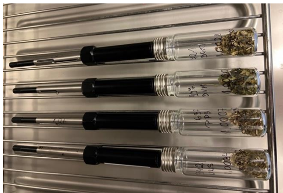
Rysunek 14. Przykład fiolek w trakcie sorpcji emitowanych LZO
