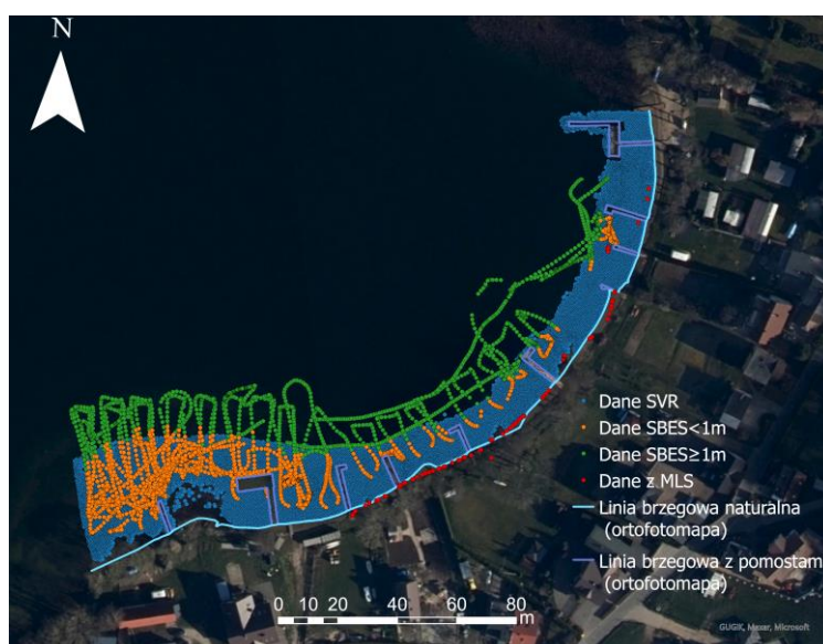
Rys. 3.8. Lokalizacja przetworzonych danych geoprzestrzennych zarejestrowanych podczas kampanii pomiarowej przeprowadzonej na jeziorze Kłodno w dniach 02-03.06.2022 r. (opracowanie własne).
