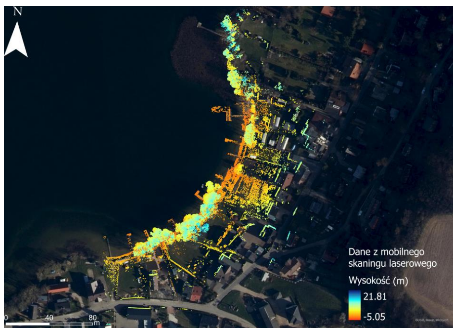
Rys. 2.23. Oczyszczona chmura punktów LiDAR z MSL dla akwenu testowego (opracowanie własne).
