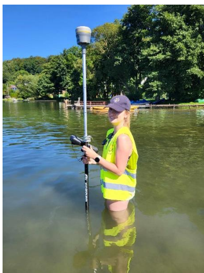
Rys. 3.14. Autorka rozprawy doktorskiej podczas realizacji pomiarów batymetrycznych akwenu metodą geodezyjną z wykorzystaniem GNSS RTK Trimble R10 na jeziorze Kłodno (opracowanie własne).
