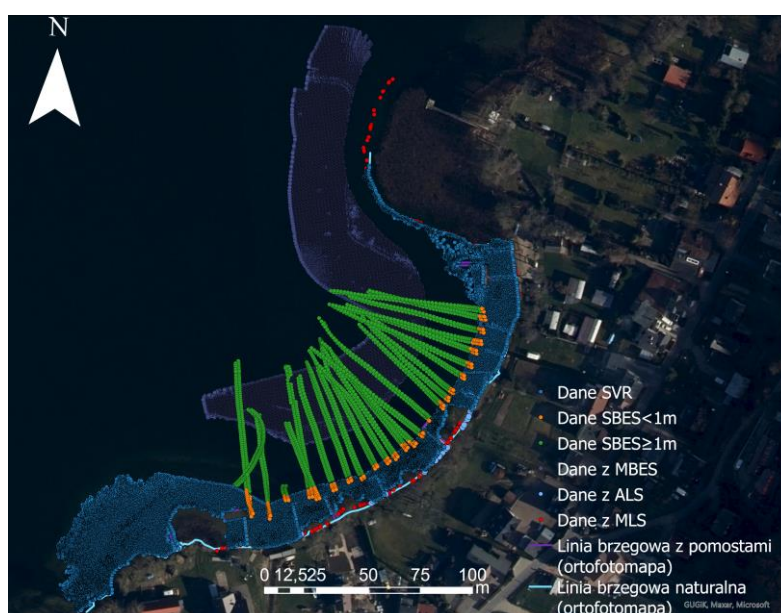
Rys. 3.15. Lokalizacja przetworzonych danych geoprzestrzennych zarejestrowanych podczas kampanii pomiarowej przeprowadzonej na jeziorze Kłodno w dniu 13.08.2024 r. (opracowanie własne).
