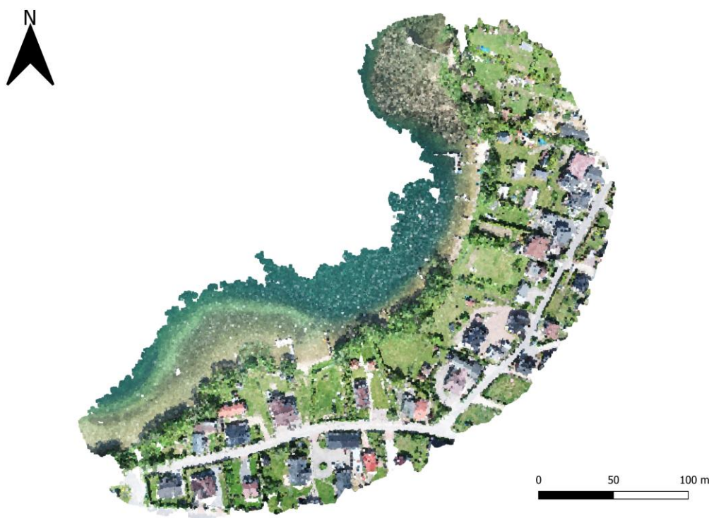
Rys. 2.13. Wygenerowana chmura punktów SfM dla akwenu testowego (opracowanie własne).
