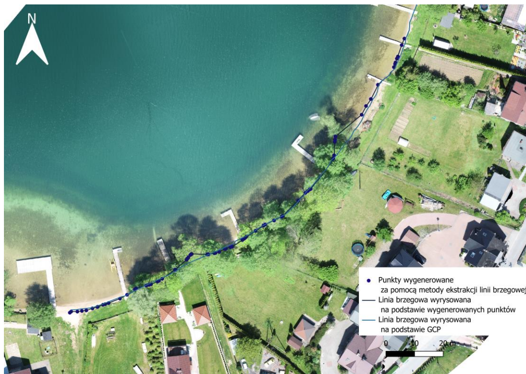
Rys. 2.26. Linia brzegowa wyrysowana na podstawie wygenerowanych punktów MSL i linia brzegowa wyznaczona przy użyciu punktów GCP dla akwenu testowego (opracowanie własne).
