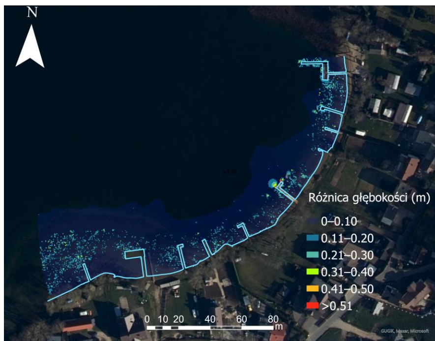
Rys. 3.23. Graficzne przedstawienie różnic głębokości między punktami pomiarowymi a odpowiadającymi im punktami wygenerowanego NMT dla jeziora Kłodno na podstawie danych zarejestrowanych podczas kampanii pomiarowej przeprowadzonej w dniach 02-03.06.2022 r. (opracowanie własne).
