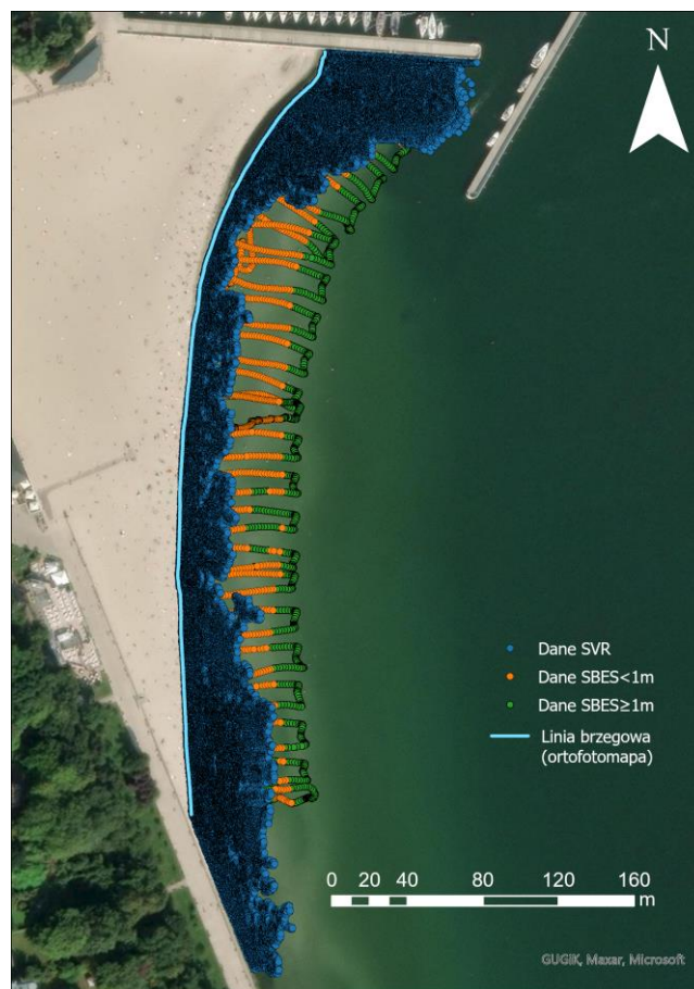
Rys. 3.3. Lokalizacja przetworzonych danych geoprzestrzennych zarejestrowanych podczas kampanii pomiarowej przeprowadzonej na akwenie morskim przyległym do plaży miejskiej w Gdyni w dniu 10.06.2022 r. (opracowanie własne).
