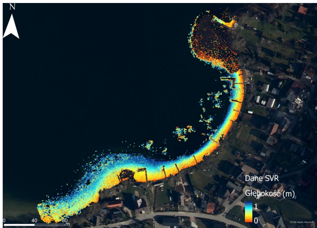
Rys. 2.14. Chmura punktów wygenerowana za pomocą metody SVR dla akwenu testowego (opracowanie własne).
