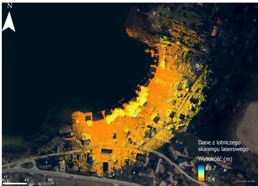
Rys. 2.19. Oczyszczona chmura punktów LiDAR z ALS dla akwenu testowego (opracowanie własne).
