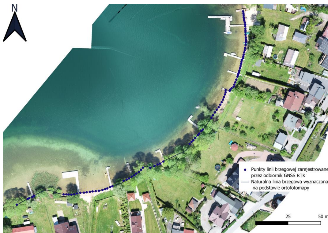
Rys. 2.27. Naturalna linia brzegowa wyrysowana na podstawie ortofotomapy i linia brzegowa wyznaczona przy użyciu punktów GCP dla akwenu testowego (opracowanie własne).
