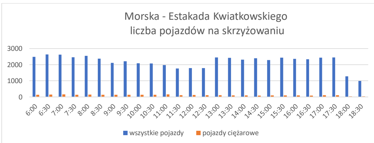
Rysunek 58 Natężenie pojazdów na półgodzinny interwał czasowy - stan istniejący Morska – Estakada Kwiatkowskiego [opracowanie własne]
