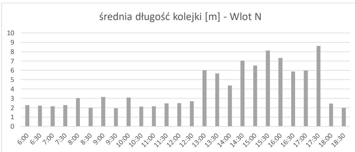
Rysunek 50 Wlot północny N – średnia długość kolejki na wlocie[m] na osi pionowej, półgodzinne interwały czasowe na osi poziomej – stan istniejący [opracowanie własne]
